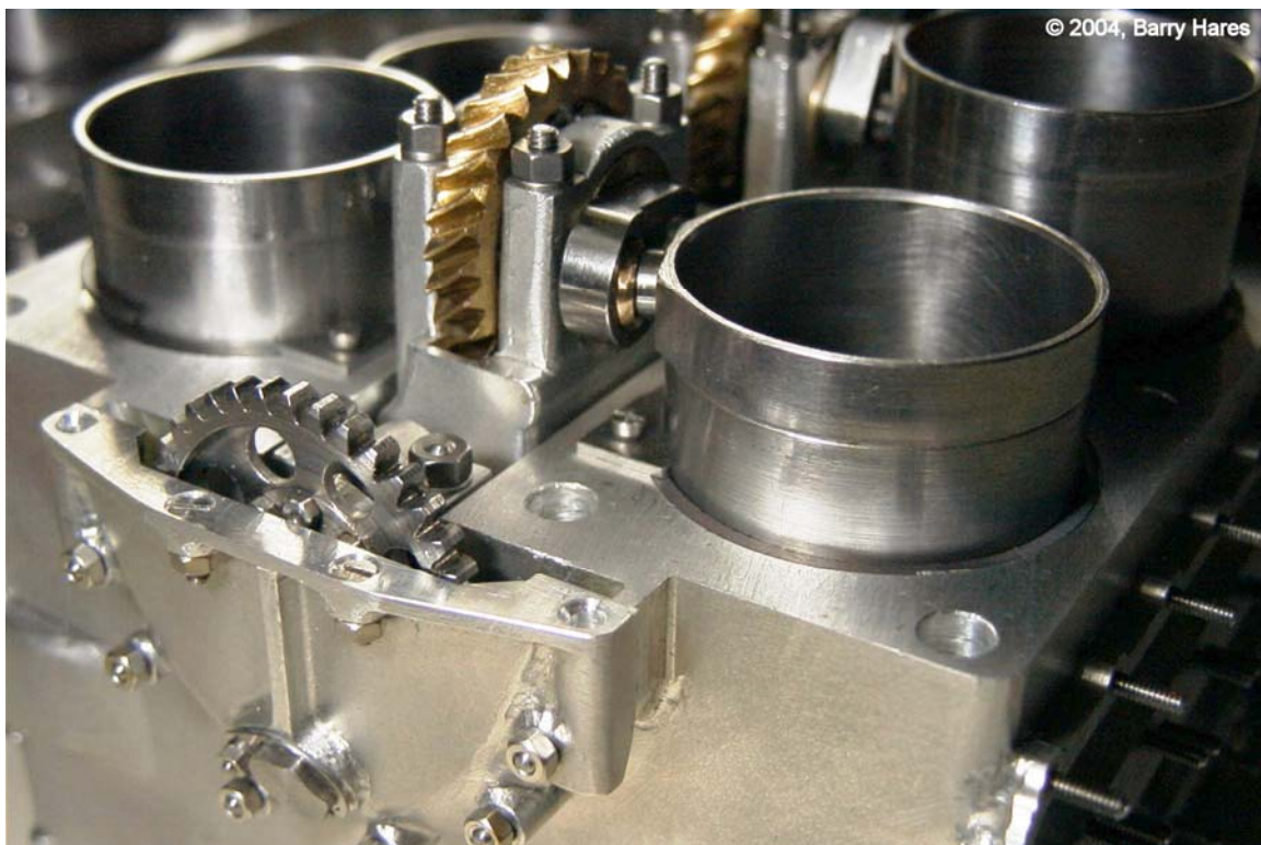
Figura 4: Mecanismo de funcionamento da válvula de luva.
